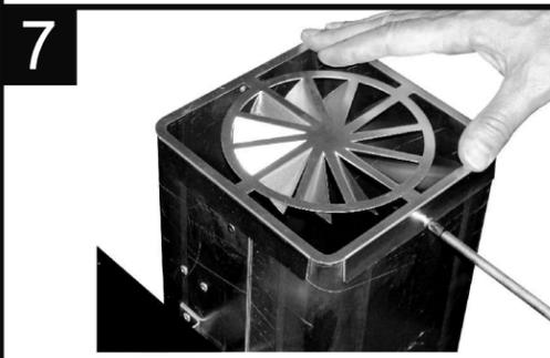
Une fois la lampe installée, placez et vissez le turbulateur (à l'aide des deux petites vis Phillips) sur le dessus du réflecteur. L'air doit passer à travers celui-ci lorsqu'il entre dans le réflecteur
