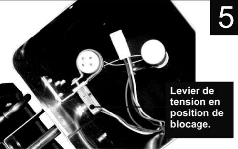
Levier de tension en position de blocage.
